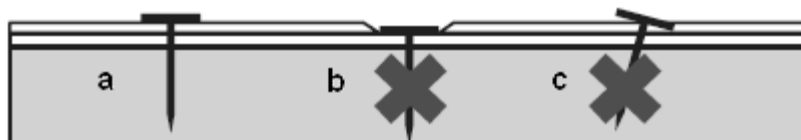
12.12 pav. Vinių kalimas: teisingai (a) ir neteisingai (b ir c)
