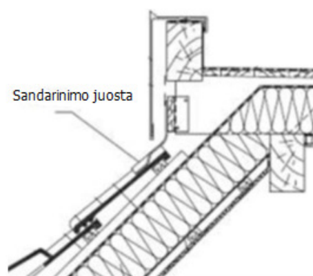
15.104 pav. Šlaito ir sienos sandūros variantas
