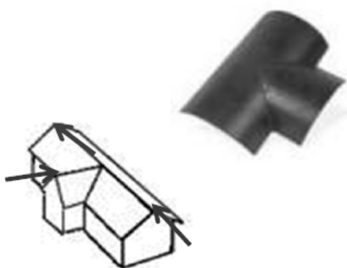
15.70 pav. Kelių horizontalių kraigų sujungimui naudojamos T čerpės
