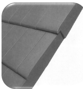
15.44 pav. Plokščių čerpių stogas klojamas šachmatine tvarka naudojant pusinės kraštinės čerpes
